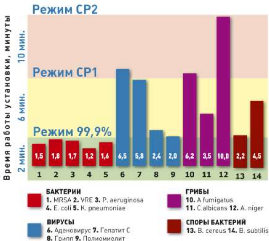
Рис. 7. Время работы импульсной УФ-установки для инаktivации различных видов микроорганизмов.
