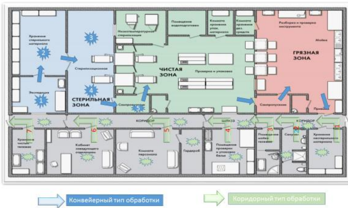
Рис. 8. Последовательность обработки зон ЦСО импульсной УФ-установкой.
